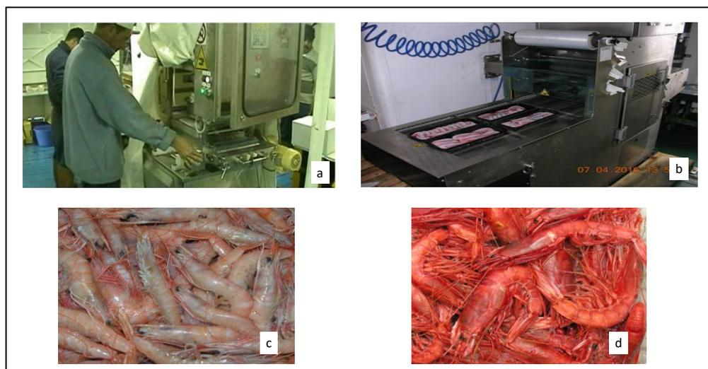
**Figura 2-** Il test di confezionamento dei gamberi senza additivi chimici: a) la fase confezionamento a bordo con una termosaldatrice MAP manuale; b) la fase confezionamento a bordo con una termosaldatrice MAP/skin automatica; c-d) campioni di gambero rosa e gambero rosso conservati sotto MAP/skin e stoccati per oltre 10 mesi a  $-18^{\circ}\text{C}$  (senza alcuna traccia di annerimento).
